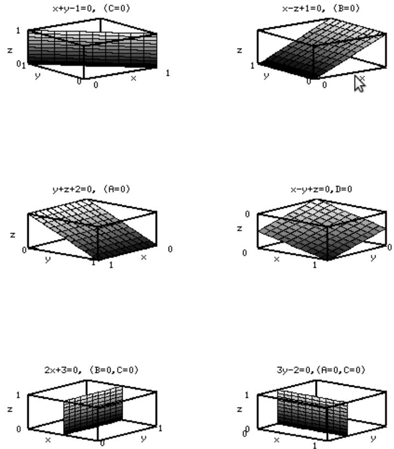
Рисунок 6.16. Особые случаи положения плоскости относительно системы координат
